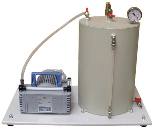
Anlage zur Erzeugung von entlüftetem Wasser
