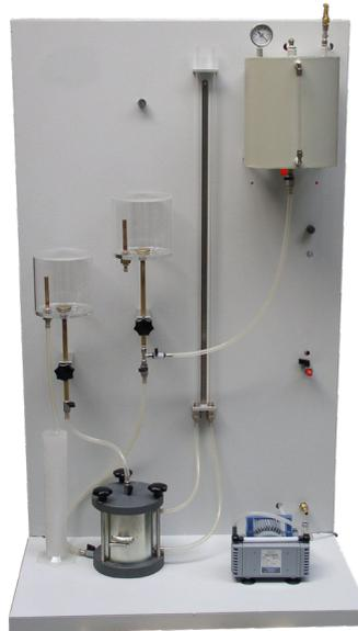
Durchlässigkeit von Sand inkl. Entgasungsanlage
