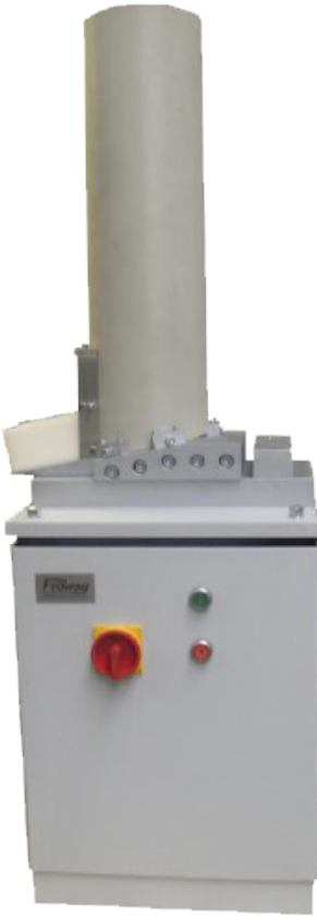
Fließeinheit nach EN 933-6 für grobe Gesteinskörnungen
