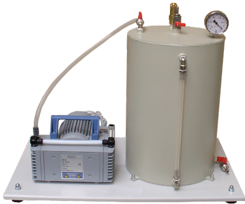
Anlage zur Erzeugung von entlüftetem Wasser
