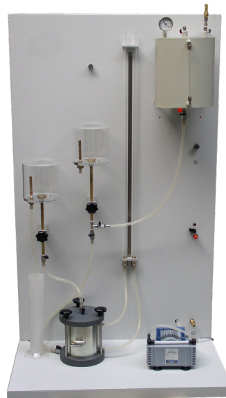
Durchlässigkeit von Sand inkl. Entgasungsanlage
