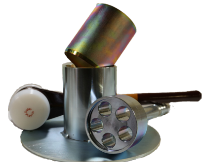
Ausstechzylinder mit Schlaghaube, Bodenplatte und Hammer
