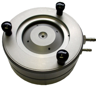
Oedometer Zelle mit festem Ring
